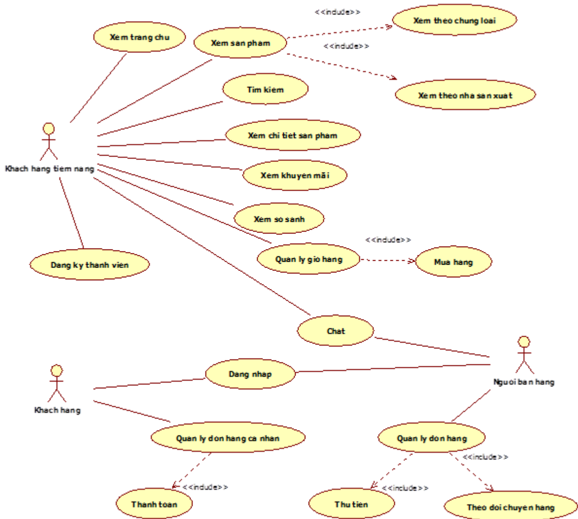
Hình 2. Bản vẽ Use Case khi bổ sung các chức năng cho “Khách hàng tiềm năng”, “Khách hàng” và “Người bán hàng”
